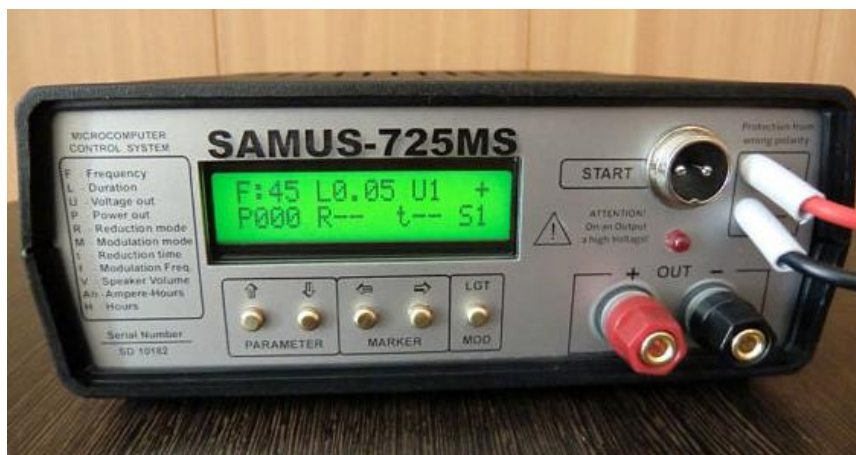
Foto 12 Aparatul de electronarcoză Samus 725 MS utilizat pentru pescuitul științific
