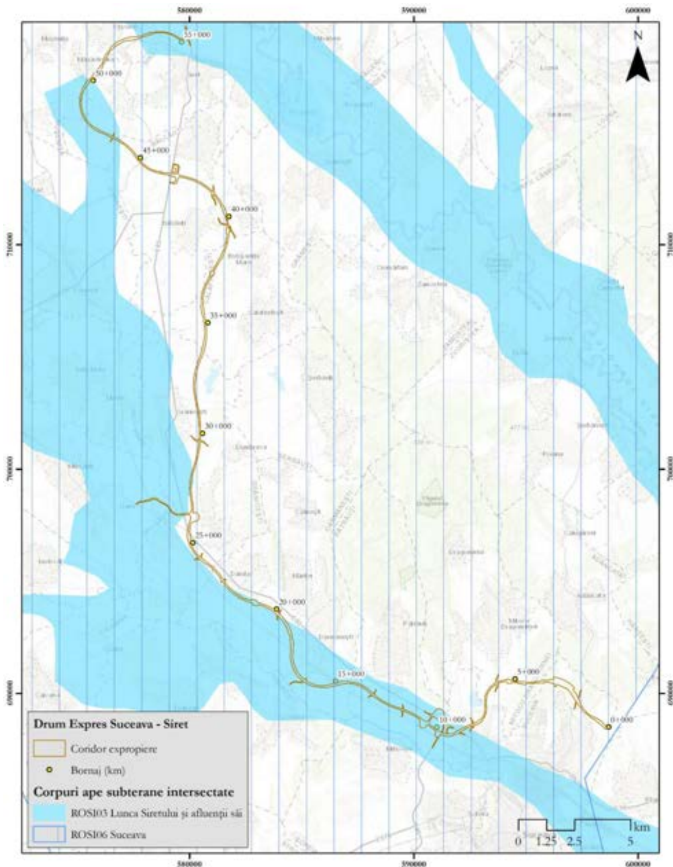
Figura nr. 5-2 Corpurile de apă subterană intersectate de proiectul autostrăzii Suceava-DN2H și drum expres DN2H-Frontiera Siret
