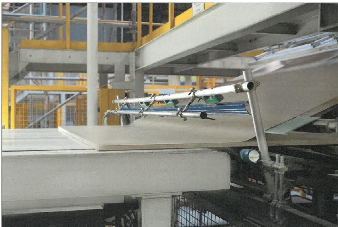
Foto 1 – Acoperire placă PAL cu hârtie impregnată
