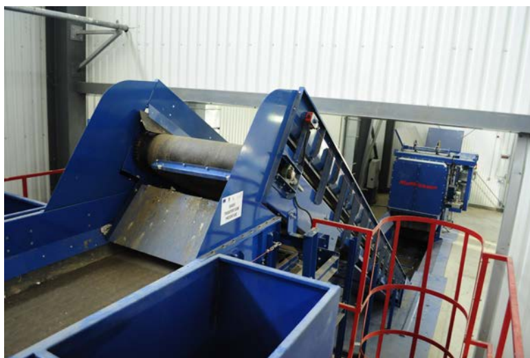
Fig. 6. Banda transportoare BT-02 și platforma de pre-sortare
