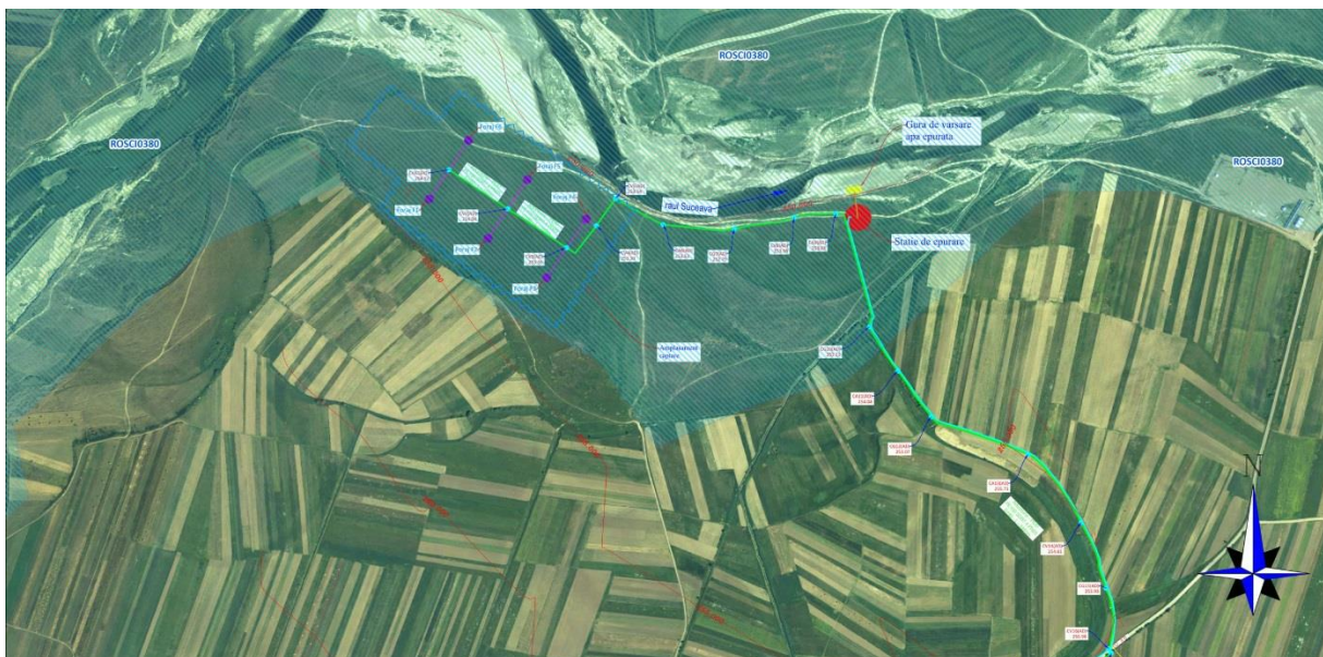
Fig. 11 Suprapunerea lucrărilor (zonă captare, stație epurare) cu perimetrul ariei protejate
