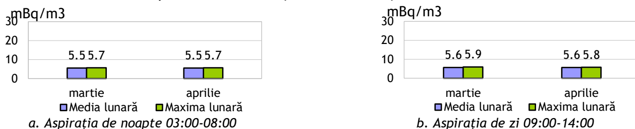
Fig. 2.2.3.1. Aerosoli atmosferici, activități specifice beta globale întârziat (la 5 zile) - valori medii și maxime în luna aprilie 2024, comparativ cu luna martie 2024
